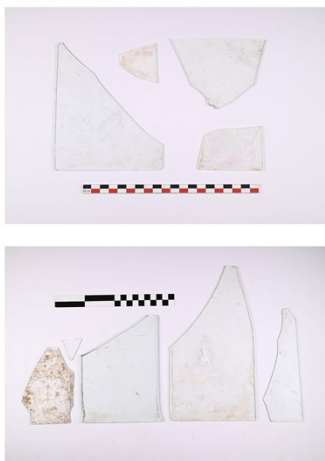
Fig. 17 : Fragments de vitres circulaires et rectangulaires de colonne de distillation de l'habitation sucrerie Vue Belle de Saint-Paul à La Réunion (Photo L. Serra, La3m UMR 7298)
